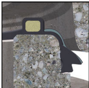
Szkic nr 1: Uszczelka samosmarująca z kompensatorem naprężeń
